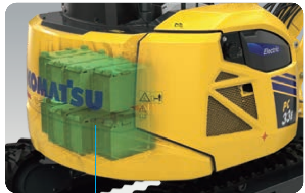
Bereich mit hoher Betriebsspannung
