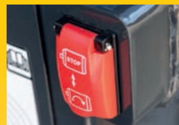
Interrupteur d'arrêt secondaire du moteur
