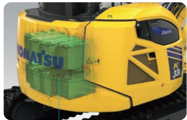
Zone à haute tension
