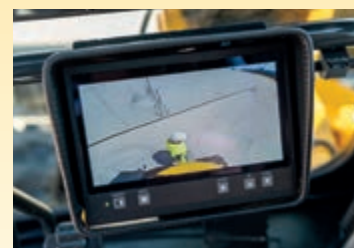
Système de caméra arrière et écran (version cabine)
