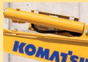
Clapets de sécurité sur vérins de flèche et de balancier
